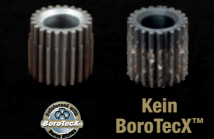
Test EN ISO-20623/ASTM D2266 zeigte, dass X1 weißes Fettspray mit BoroTecX™ Standard-Fettspray um bis zu ein vierfaches übertrifft.
