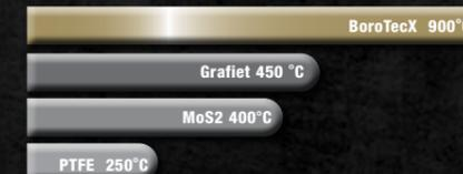
BoroTecX™ est capable de résister à des températures allant jusqu'à 900 °C
