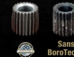
Le test EN ISO-20623 / ASTM D2266 a démontré que la graisse blanche X1 contenant BoroTecX™ pouvait surpasser jusqu'à 4 fois les performances des graisses standard.
